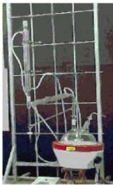
Figura 17: Aparelhagem adaptada tipo Clevenger (Foto: prof. Miguel Fascio).
