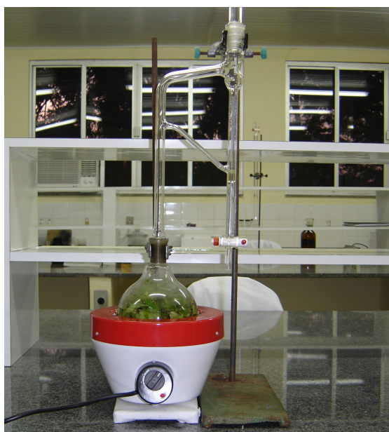
Figura II.1 - Aparelhagem do tipo Clevenger, utilizado na extração dos óleos essenciais.
