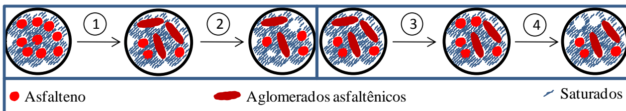
Figura 6.7 – Representação do mecanismo termoforético e formação de aglomerados que ocorre na célula com petróleo quando irradiada pelo laser de excitação. (1) formação de aglomerados, (2) migração de aglomerados, (3) desagregação de aglomerados e (4) migração de fluoróforos. Adaptado do trabalho de Braun e colaboradores [Braun, 2002].
