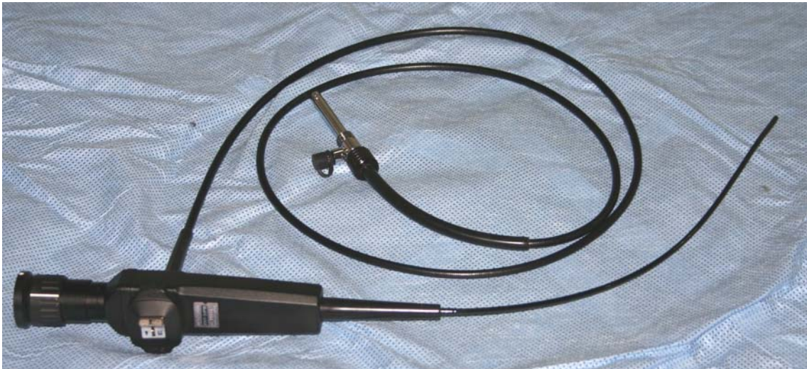
Figura 3 Endoscópio flexível utilizado (3,2 mm, da marca Maschida).
