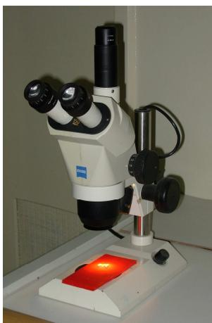
**Figura 15** – Lupa estereoscópica
