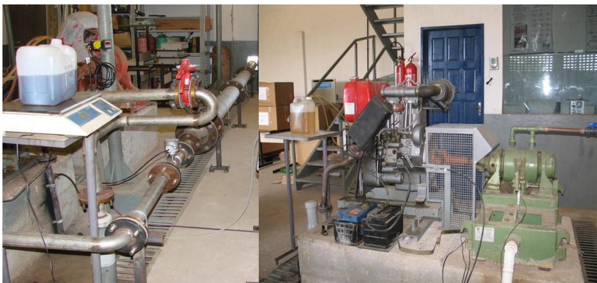
Figura 4 Laboratório de Motores: Bancada dinamoétrica acoplada a um sistema de diluição a volume constante.
