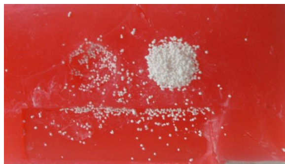
Figura 8 – Preenchimento da cera utilidade com microesferas de HA, simulando uma condição clínica
