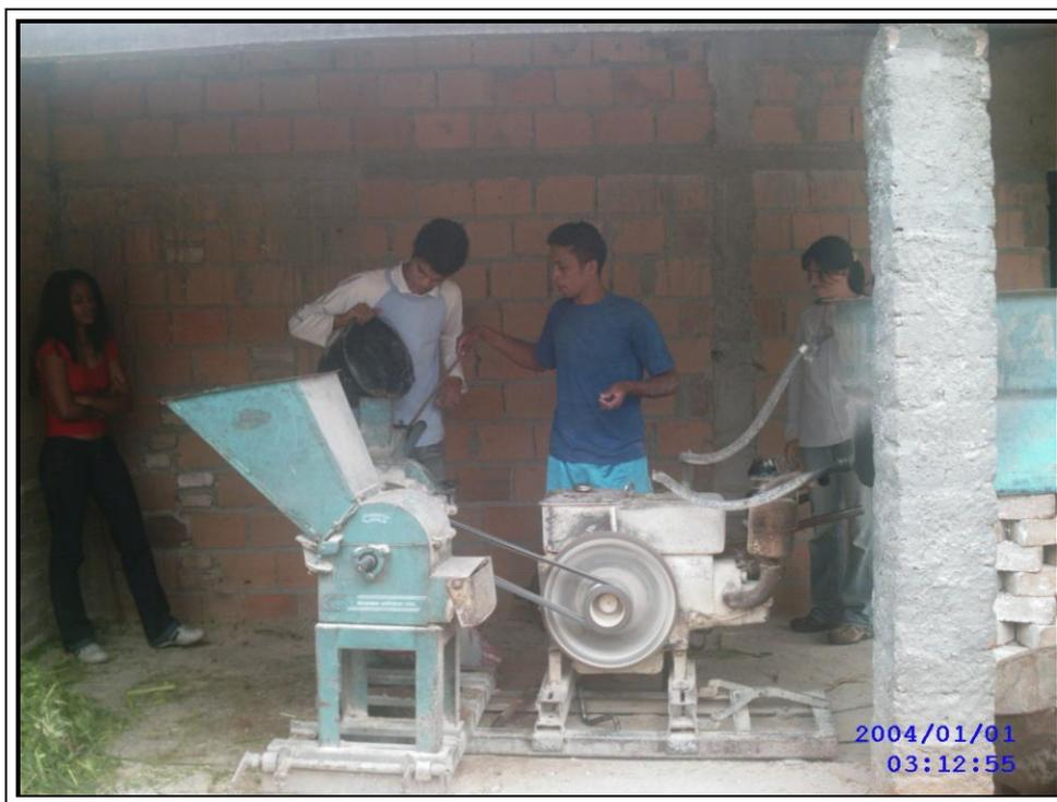
**Ilustração 5.** Motor e máquina de forrageira: preparando a ração para a criação.
