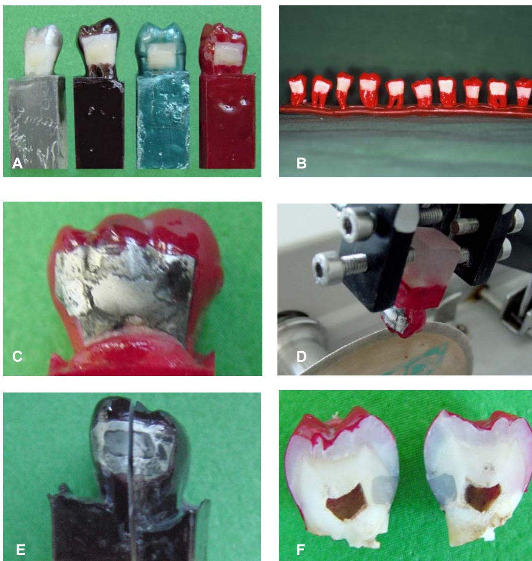
Figura 2 – Preparo dos dentes para o teste de microinfiltração: A) Espécimes de diferentes grupos experimentais impermeabilizados com esmalte para unhas; B) Espécimes do grupo 4 após a impermeabilização; C) Espécime incluído em resina acrílica e após imersão no agente traçador; D) Espécime fixado na máquina de corte; E) Espécime seccionado no sentido vestibulo-lingual; F) Espécime seccionado e pronto para leitura em lupa estereoscópica.
