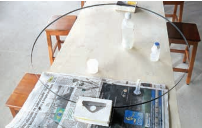
Figura 46. O arco é inserido no molde de silicone (autor, 2013).
