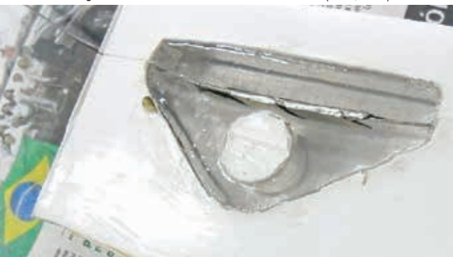
Figura 47. A resina é despejada no molde de silicone (autor, 2013).
