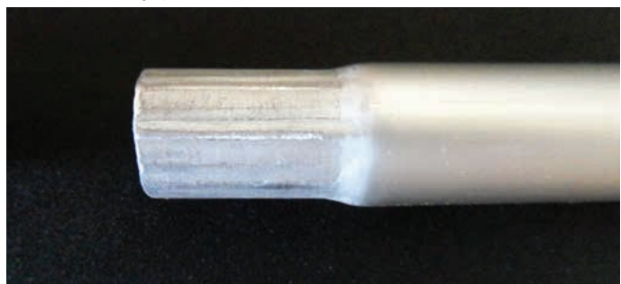
Figura 18. Ponta da haste prensada para encaixar (autor, 2013).
