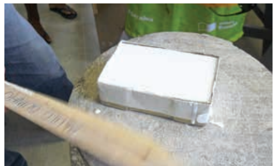
Figura 43. Retirando as bolhas de ar do silicone (autor, 2013).
