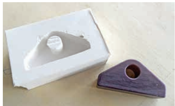
Figura 44. Retirada do modelo de cera do molde de silicone (autor, 2013).
