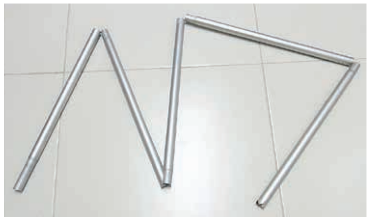
Figura 56. Haste articulada completa (autor, 2013).
