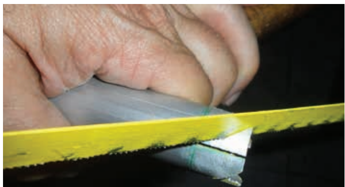
Figura 19. Confecção da extremidade inferior da haste (autor, 2013).
