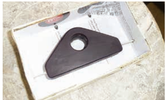
Figura 41. O modelo de cera é inserido na caixa de papelão (autor, 2013).
