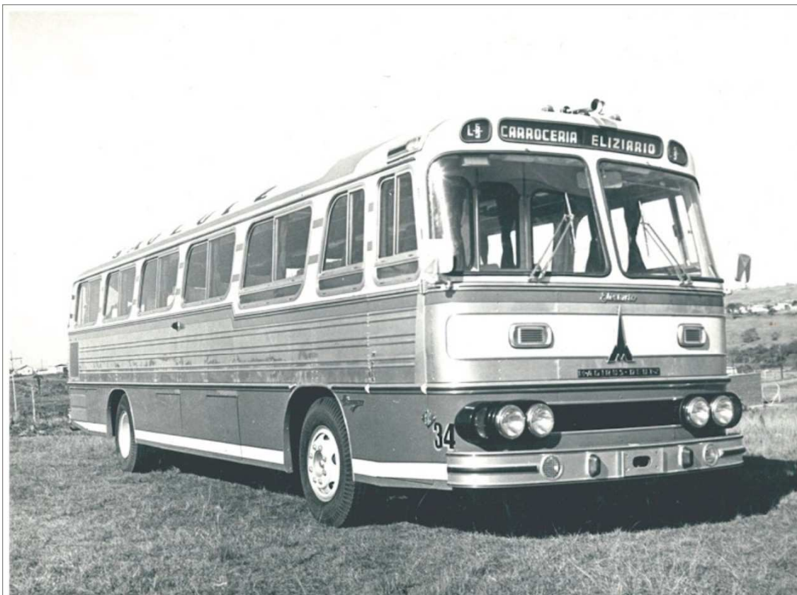
Figura 33: evoluindo. Ônibus da nova frota da Empresa de Transportes São Luiz utilizado nas linhas que ligavam Jacobina, Juazeiro e Senhor do Bonfim a Salvador a partir de 1968. Encarçoado pela Carrocerias Elizario de Porto Alegre-RS, possuía chassi Magirus Deutz, de origem alemã, cuja fábrica ficava no Centro Industrial de Aratu. Nota-se o grande contraste entre este modelo e o “mixto” com o qual a empresa iniciou os serviço nos anos 40. Fonte: Acervo da empresa.
