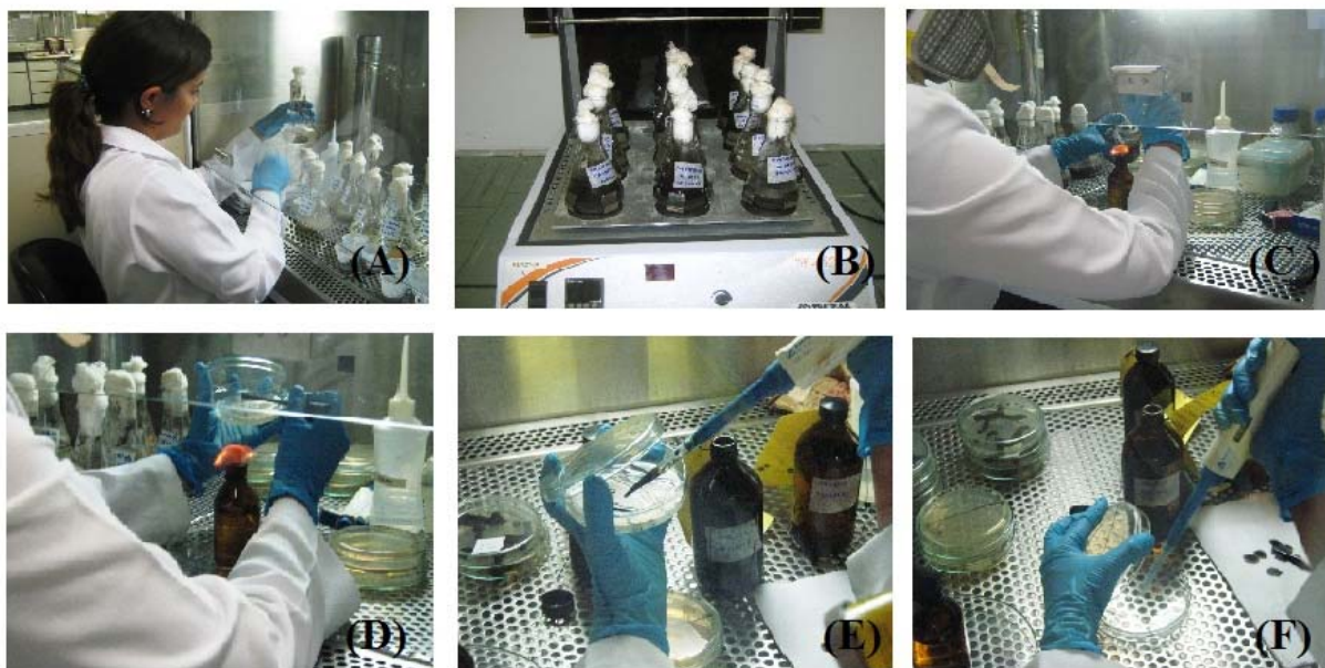
Figura 3. Procedimentos microbiológicos. (A) – Enriquecimento das amostras em 99 mL de caldo BH e 1% de um dos petroderivados como fonte de carbono; (B) – Amostras submetidas à agitação em 180 rpm, 28\pm 2 durante 21 dias; (C) – Obtenção das amostras enriquecidas; (D) – Semeadura das amostras enriquecidas em placas com ágar BH; (E) – Adição do petróleo e óleo diesel sobre a amostra semeada; (F) – Adição da gasolina na tampa da placa de Petri.
