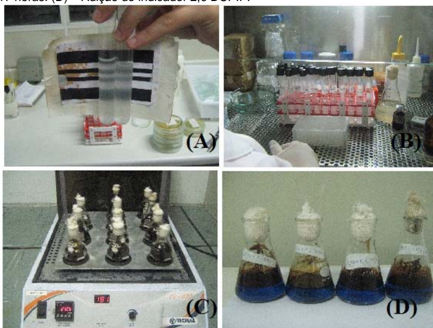
Figura 4. Ensaio de Seleção. (A) Preparo da Suspensão bacteriana padronizada em 1,5 \times 10^8 UFC. (B) – Placa multipoço utilizada no primeiro ensaio de seleção. (C) – Cepa enriquecida em caldo BH e fonte de carbono em agitação a 180 rpm, 28\pm 2 e 17 horas. (D) – Adição do indicador 2,6 DCPIP.
