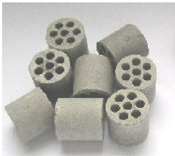
Figura 2.6. Ilustração do catalisador comercial de níquel suportado em alumina para a reforma a vapor (FERTILIZERS..., 2009)
