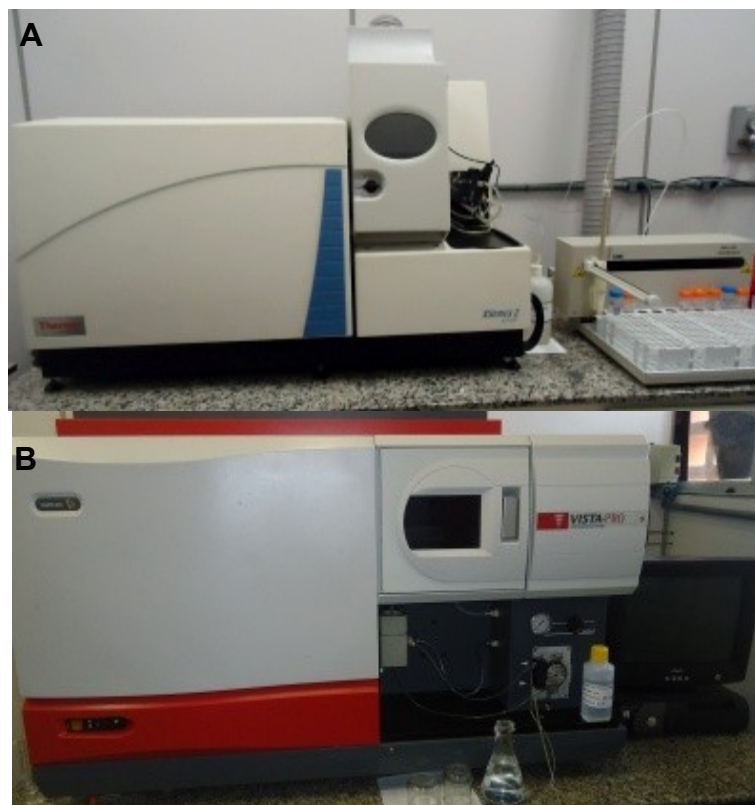
Figura 5 - Instrumentos empregados na determinação dos elementos químicos: A - ICP-MS; B - ICP OES
