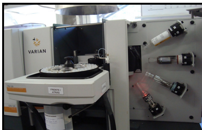
Figura 13 – Aparelho de Espectrometria de Absorção Atômica com Forno de Grafite. Fonte – Acervo do Laboratório de Toxicologia da Faculdade de Farmácia da UFBA.
