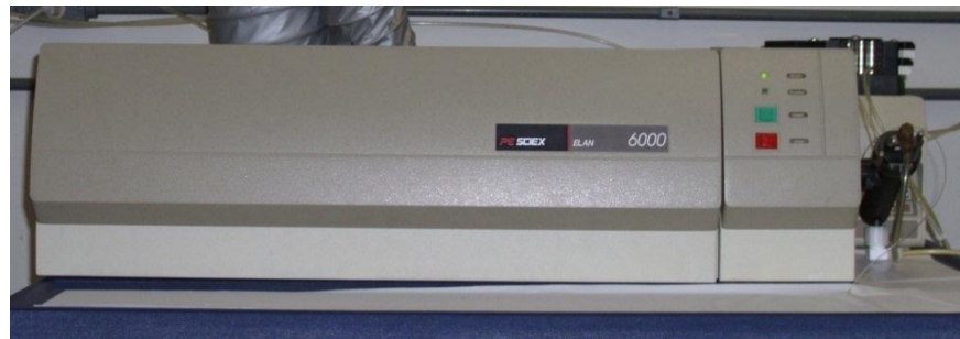
Figura 6 - Espectrômetro de massas com plasma indutivamente acoplado.
