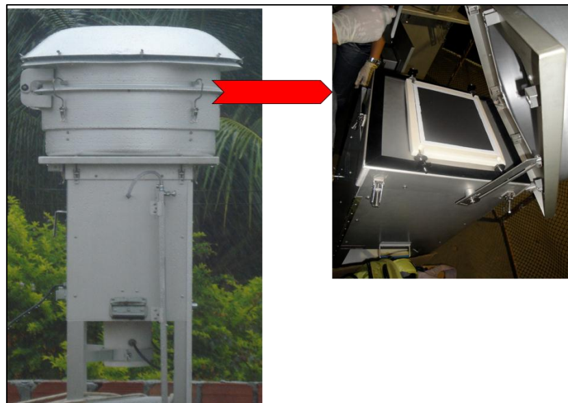
Figura 25 - Amostrador do tipo Hi Vol utilizado na amostragem, em destaque o filtro após amostragem.
