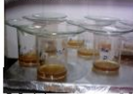
7- 5 mL da amostra com adição de 5 mL de Peróxido de Hidrogênio em Becker e uma pitada de Dicromato de potássio. Permanência por 24h na placa aquecedora (50°C).
