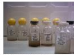
9- Toda a amostra centrifugada foi traferida com volume de 15 mL para frascos devidamente identificados.
