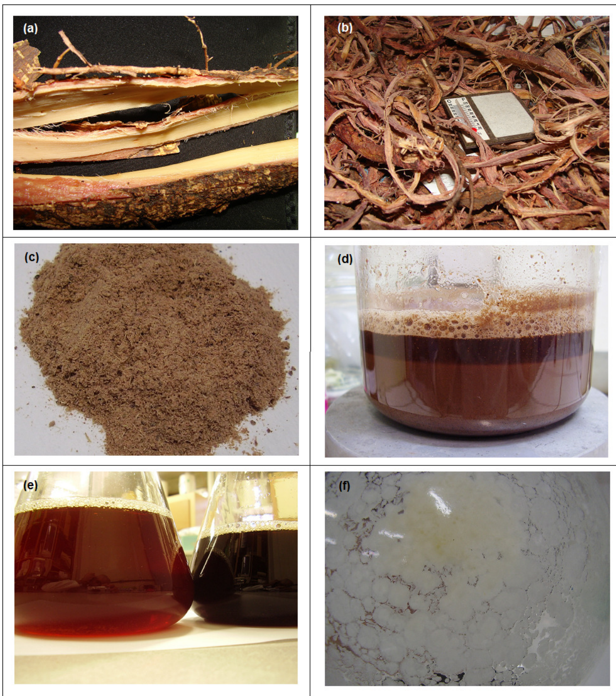
Figura 13. Fotos do processo de isolamento do DMT a partir da M. tenuiflora . (a) Cascas da raiz de M. tenuiflora ; (b) Cascas secas em estufa com ar circundante; (c) Cascas moídas e secas; (d) Cascas em solução ácida (pH 2); (e) Extratos aquosos de M. tenuiflora (vinho da jurema); (f) DMT impuro obtido pela cristalização em hexano. Nota-se a presença das frações amarela e branca. Fotos: Alain Gaujac
