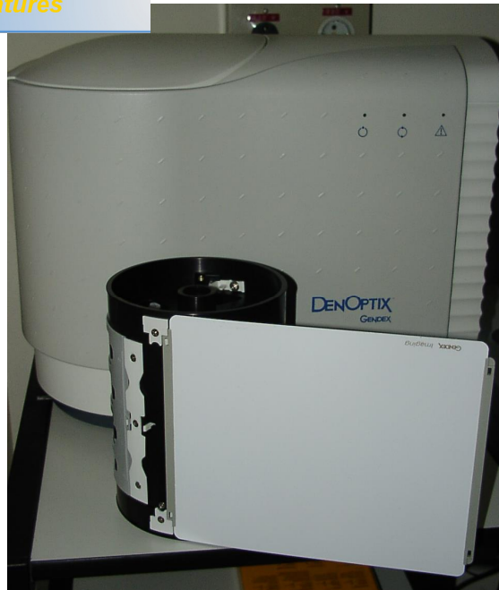
Figura 6: Placa de imagem do Sistema DenOptix ® sendo posicionada no suporte para captura da imagem na unidade de leitura
