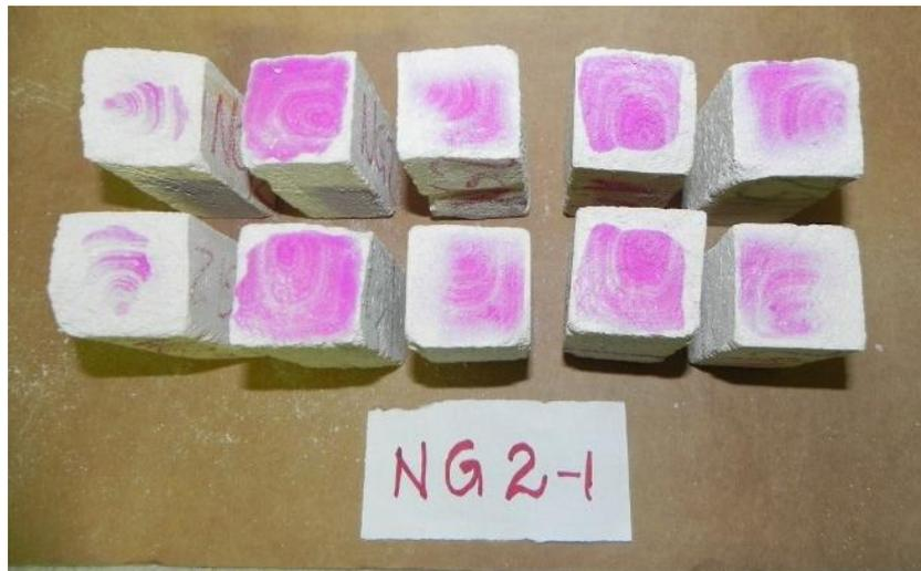
Figura 40: Carbonatação nos CP com 2% de aditivo.
