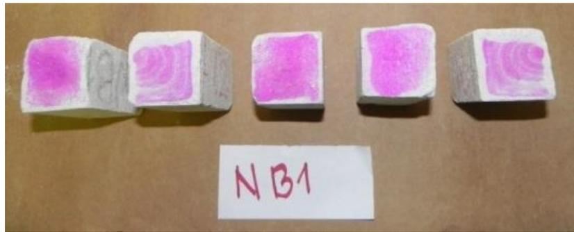
Figura 39: Carbonatação nos CP sem aditivo.
