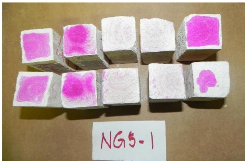
Figura 41: Carbonatação nos CP com 5% de aditivo.
