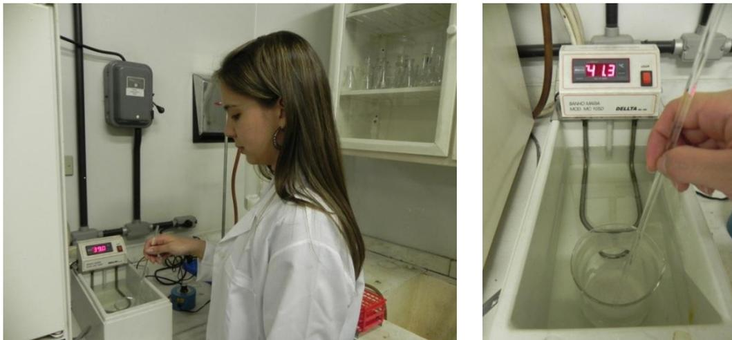
Figura 21: (A e B) Aquecimento em banho maria, 24 horas após a hidratação da cola.
