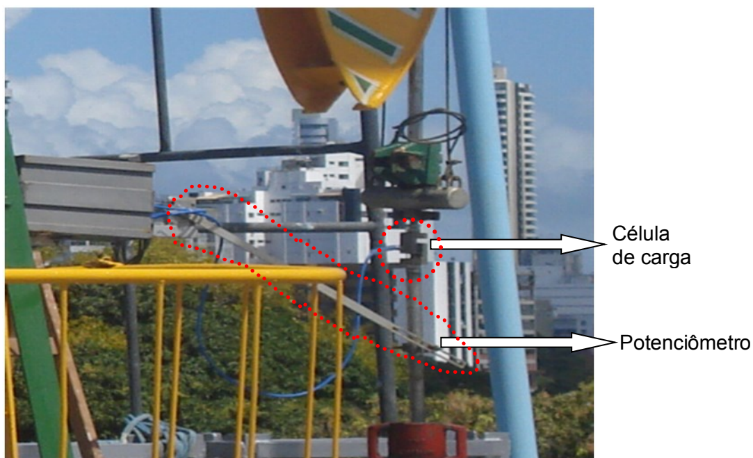
Figura 5.3: Detalhe para a disposição da célula de carga e do potenciômetro instalados na haste polida.
