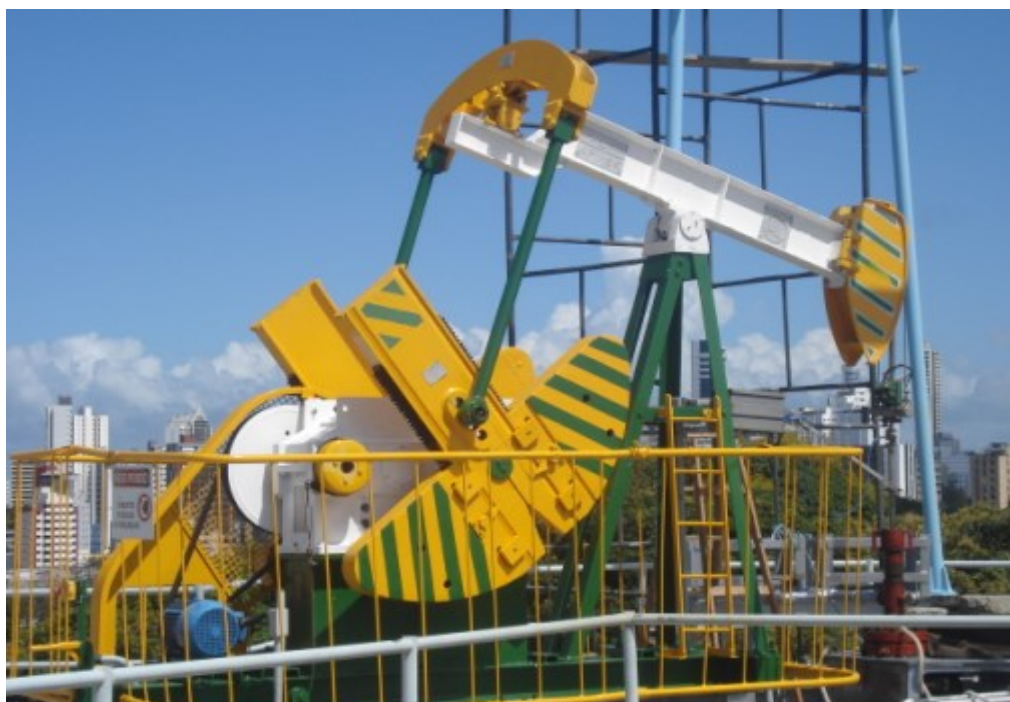
Figura 5.2: Unidade de bombeio instalada na Escola Politécnica da Universidade Federal da Bahia.
