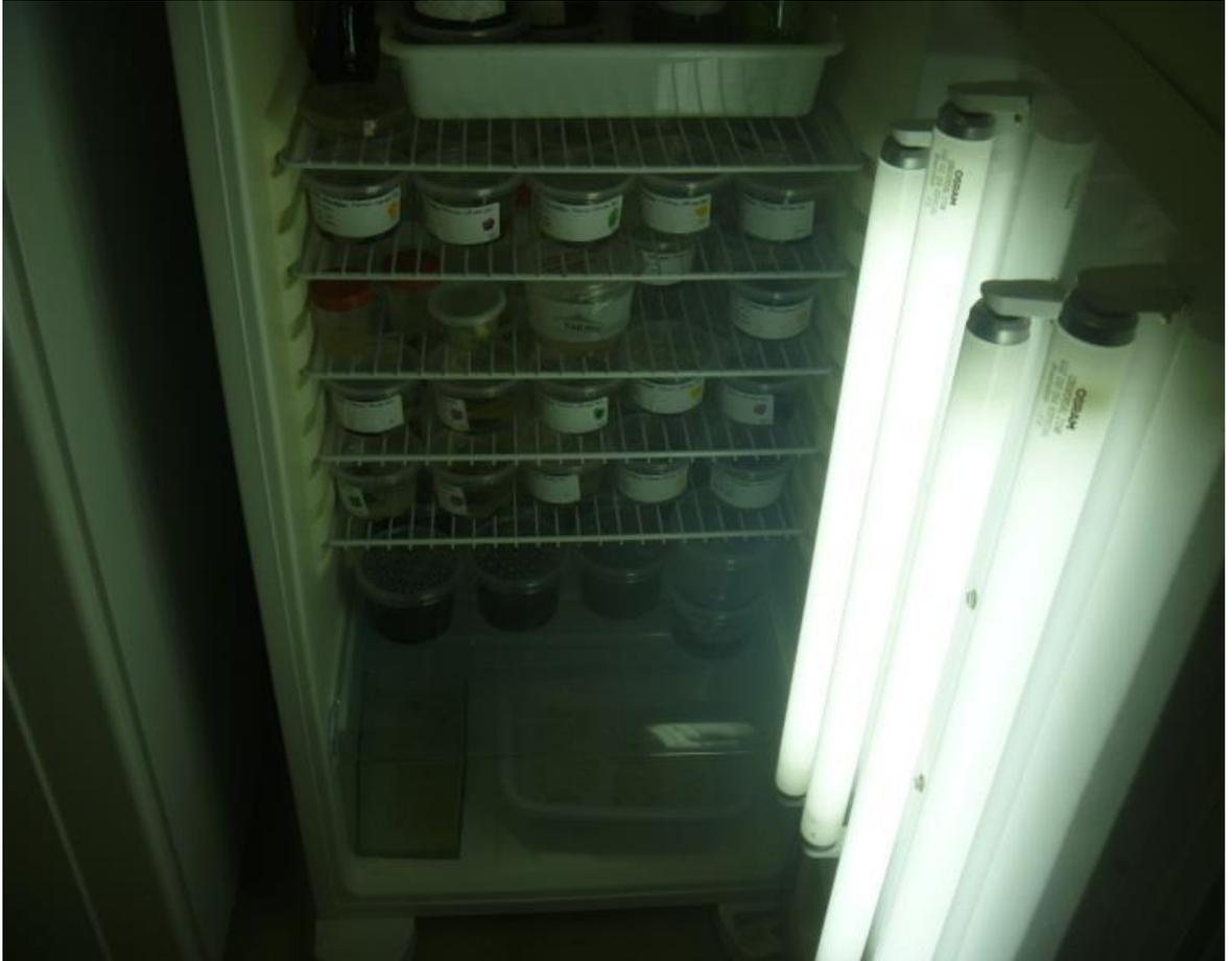
**Figura 6.** Câmara de germinação (temperatura 22°C, fotoperíodo 12h).
