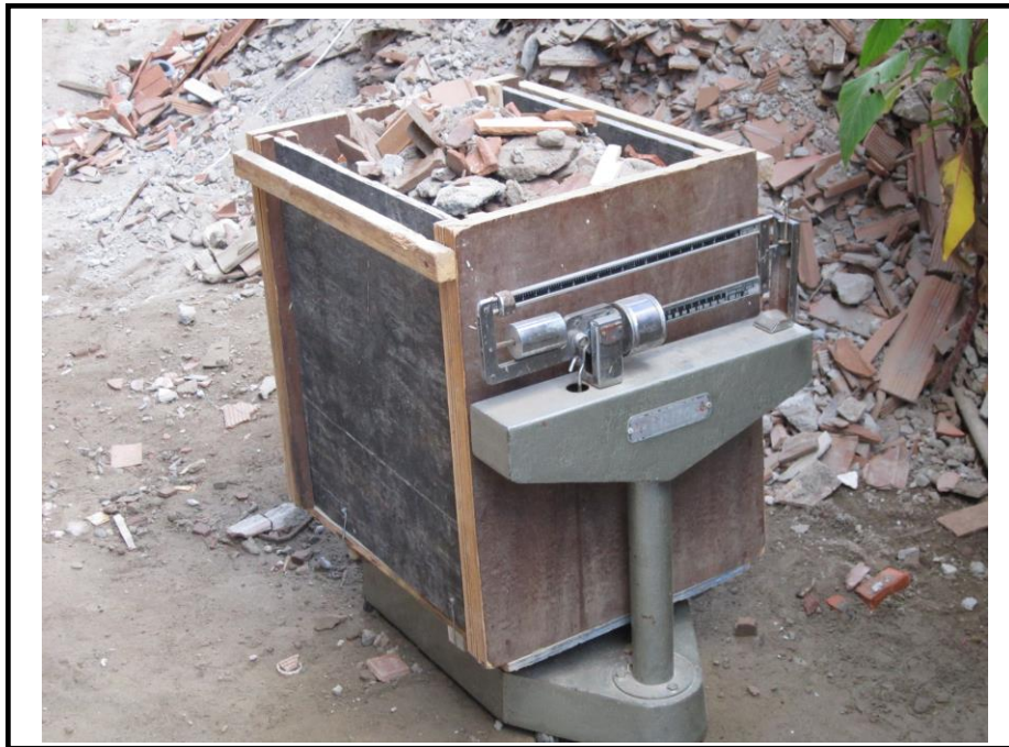
Figura 3.3: RCC segregado na hora da pesagem Fonte: Autor da pesquisa (maio/2011).
