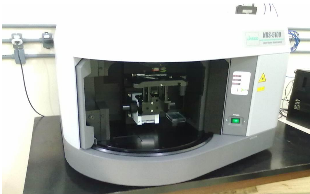
Fig.12: Fotografia do espectrômetro Raman (JASCO NRS5-100) do laboratório LAPO/LAMUME/IF da UFBA utilizado nas análises apresentadas neste trabalho.
