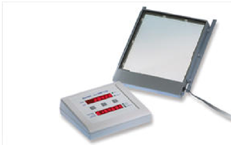
Figura 13 - Medidor de produto kerma-área IBA® DOSIMETRY modelo Kerma X plus DDP TinO
