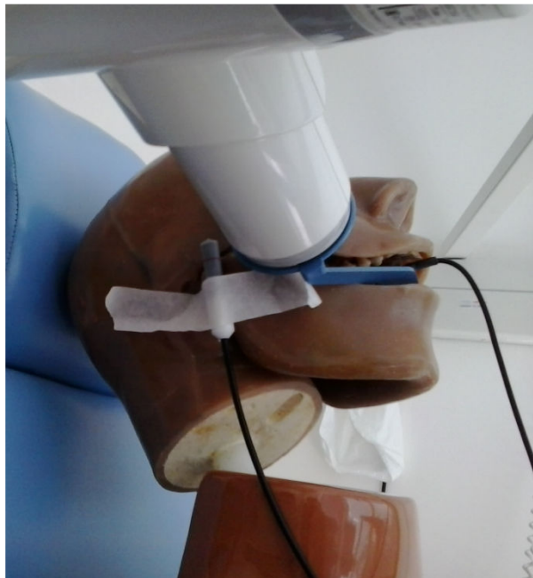
Figura 19 - Protótipo de cabeça e pescoço com sensor e câmara de ionização em glândula parótida
