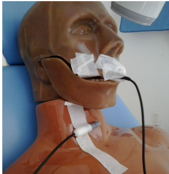
Figura 21 - Protótipo de cabeça e pescoço com sensor e câmara de ionização em glândula tireoide
