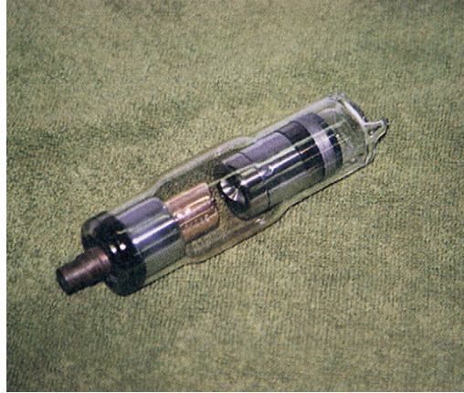
Figura 3 - Tubo de raios X com ânodo fixo Fonte: Bushong (2009, p.125).
