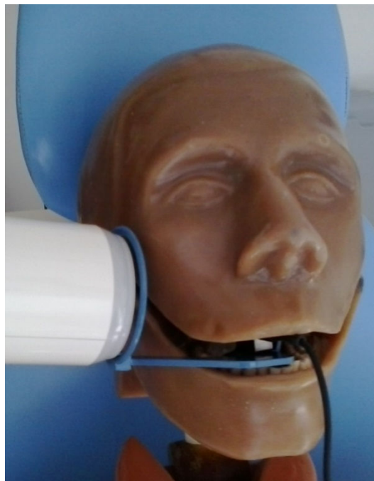
Figura 16 - Posicionador no local apropriado para realizar a medição de dose
