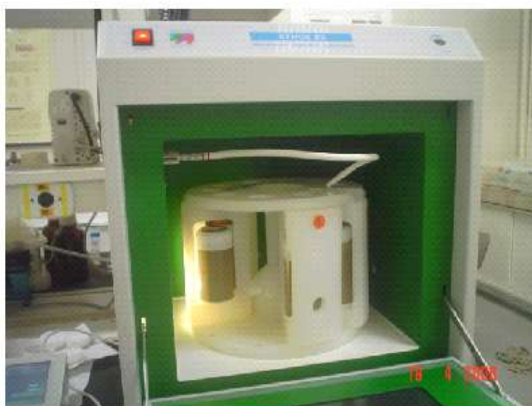
Figura 17. Forno de micro-ondas com cavidade utilizado na digestão das amostras de moluscos bivalves.
