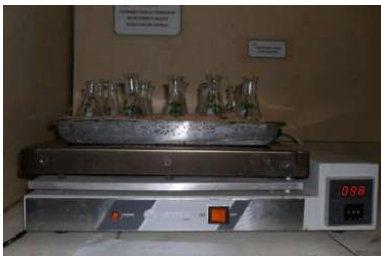
Figura 29. Banho de areia para extração de V(V) em amostras de sedimento.
