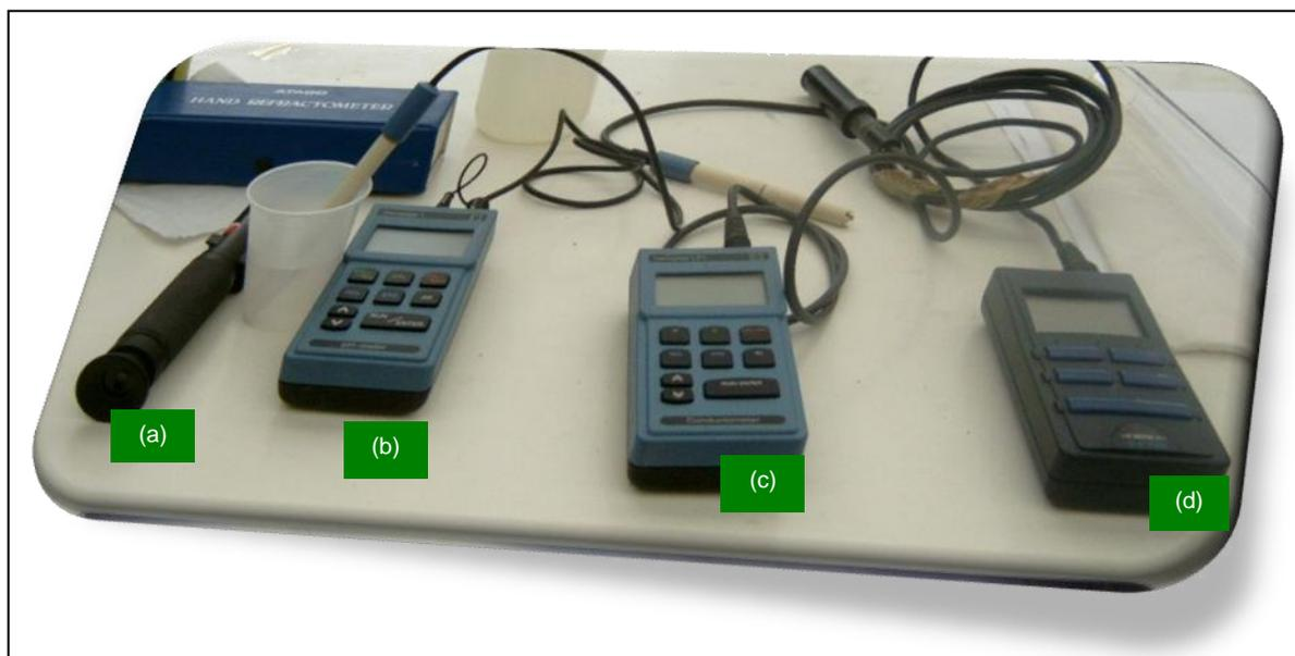
Figura 34. Equipamentos utilizados para mensurar os parâmetros físico-químicos. (a)refratômetro, (b) pH-metro, (c) condutivímetro e (d) oxímetro.
