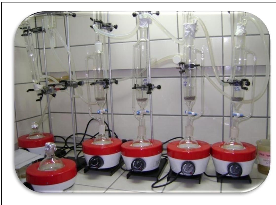
Figura 36. Sistema *Soxhlet* utilizado para extração dos hidrocarbonetos totais de petróleo (HTP) no sedimento.
