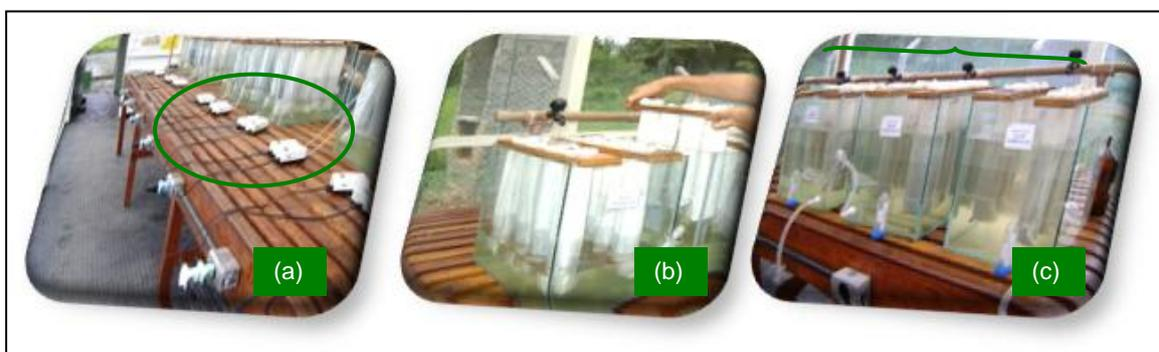
Figura 30. Terceira etapa da montagem do experimento. Montagem das bancadas: (a) bombas instaladas (b) provetas sendo colocadas no aquário (c) sistema de torneiras ligadas.
