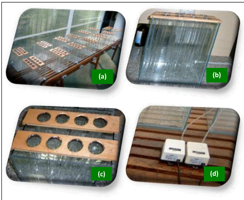
Figura 2. (a) Bancadas com aquários (unidades de simulação); (b) tubos de ensaio (provetas); (c) barras de madeira e (d) bombas de aquário.
