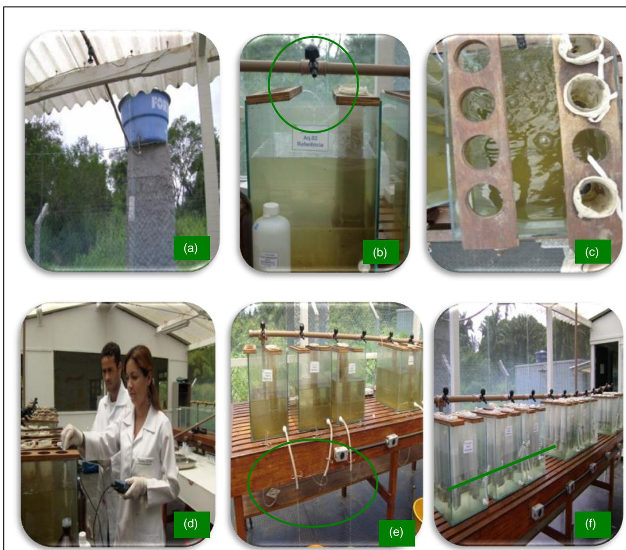
Figura 31. Etapas de um dia de Simulação. (a) Tanque de armazenamento de água, (b) sistema de torneira com uma pequena vazão, (c) aquário mostrando bolhas de ar, (d) parâmetros sendo mensurados, (e) aquários esvaziados com uma pequena vazão e (f) limite de água deixado nas unidades de simulação.
