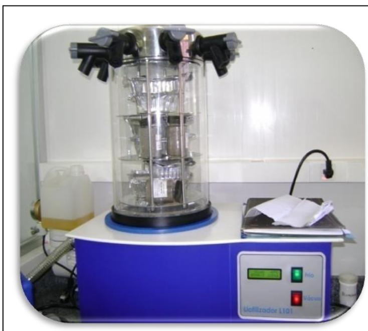
Figura 35. Aparelho Liofilizador L101 utilizado para retirar a umidade das amostras.
