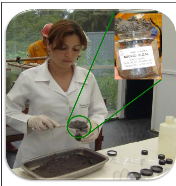
Figura 33. Coleta de amostras de sedimento para análise Hidrocarbonetos Saturados, amônia, nitrato, fósforo, carbono orgânico e granulometria.
