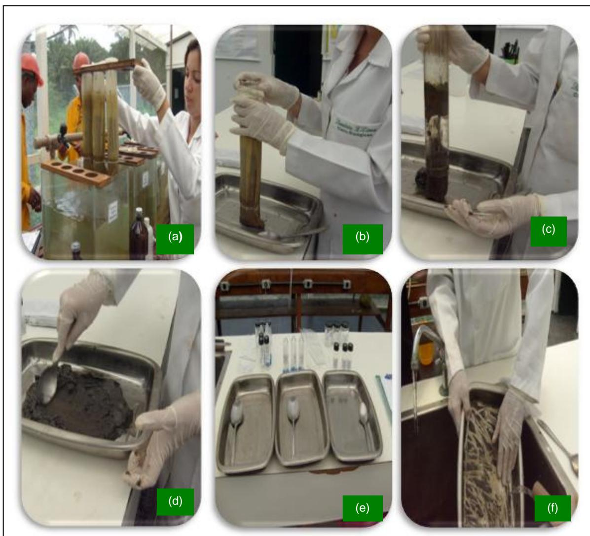
Figura 32. Procedimento de retirada das amostras das unidades de simulação. (a) Provetas com amostras, (b) e (c) proveta retirada do aquário, (d) amostras sendo homogeneizadas, (e) recipientes individuais para cada triplicata de aquário e (f) lavagem da bandeja entre a homogeneização das amostras.
