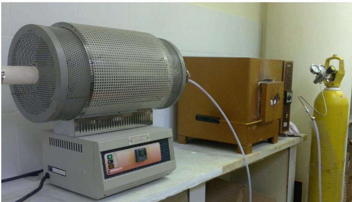
Figura 4.2 - Forno utilizado para a redução.
