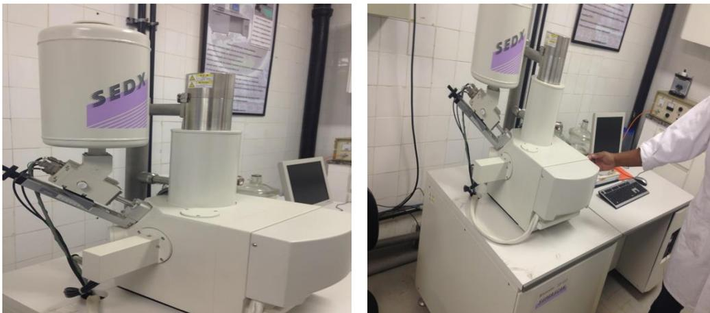
Figura 36 – Microscópio eletrônico de varredura Superscan Shimadzu modelo SS-550 utilizado para registro de imagens do espaguete.
