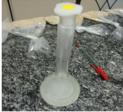
Figura 35 – Solução de sólidos solúveis extraídas após cocção do espaguete.
