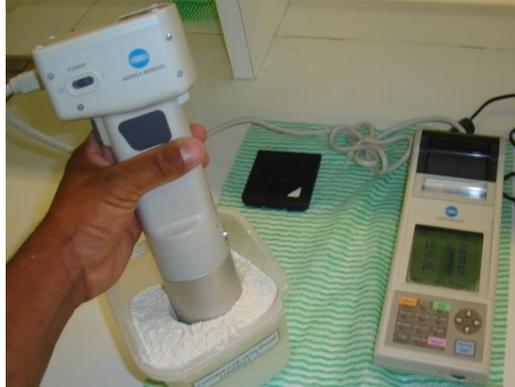
Figura 30 – Análise da cor no colorímetro digital (Konic Minolta).
