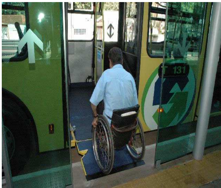
Figura 6 – Veículo com piso rebaixado, Uberlândia-MG. FONTE: Gilmar Rabelo 2006.
