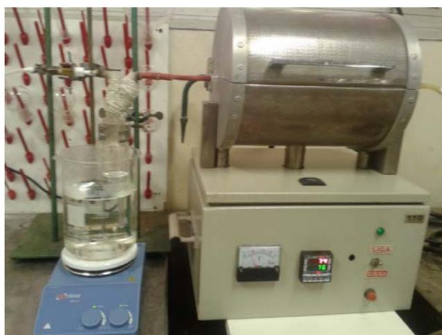
Figura 3.3. Forno mufla utilizado nos tratamentos térmicos durante as etapas de obtenção dos carvões, acoplado a um sistema de geração de vapor d'água.
