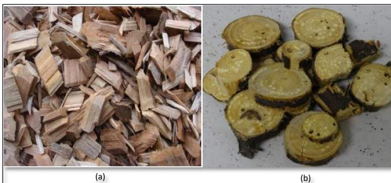
Para padronização e referência dos ensaios de termoconversão e físico-químicos, todas as amostras foram inicialmente secas a 105°C durante 24 horas, conforme norma ASTM E 871-82<sup>6</sup>.
