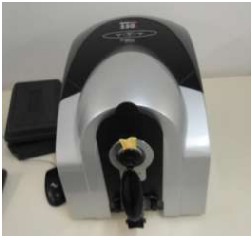
Figura 21. Espectrofotômetro utilizado nas análises colorimétricas Fonte: Própria Autora
