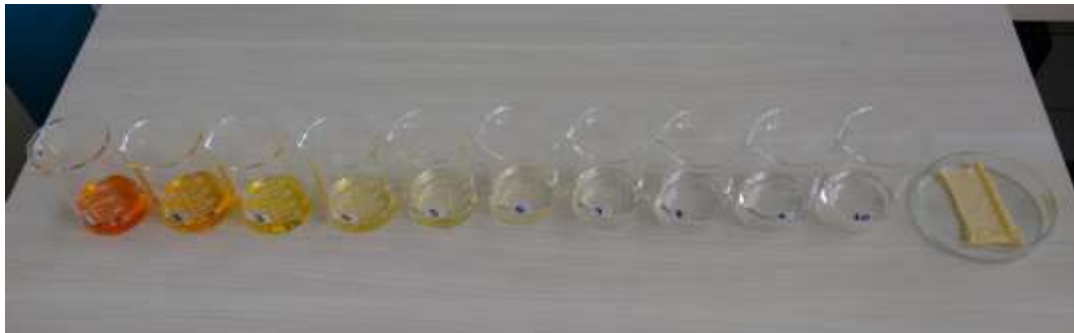
Figura 17. Unidade de extração de LIP + corante – Etapas de extração
