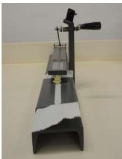
Figura 24. Crockmeter manual TEXCONTROL®
