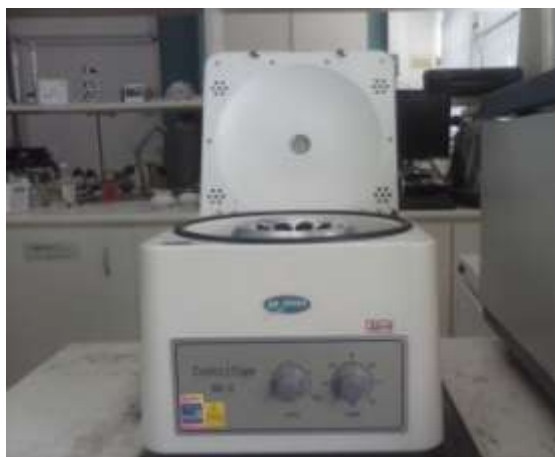
Figura 18. Centrífuga usada para sedimentação de corante não solubilizado em LIP.
