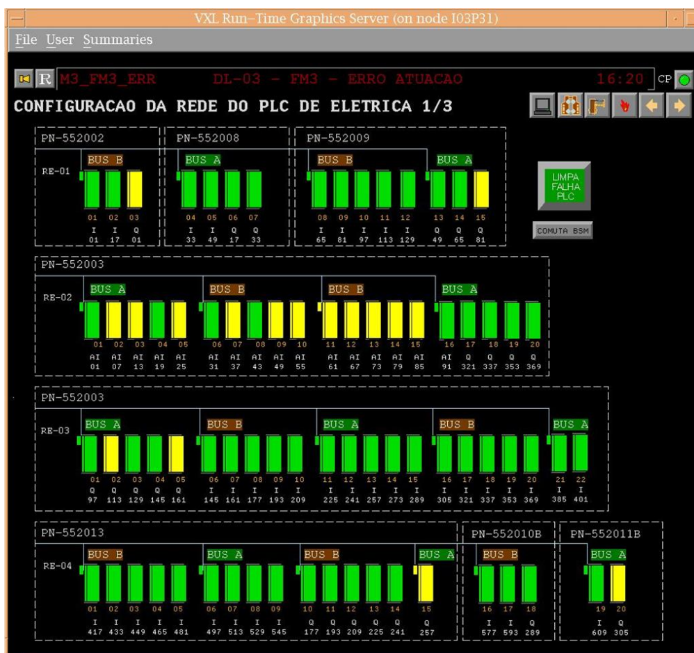
Figura 5.6 - Tela de diagnóstico para o pessoal a bordo (malha rápida) que mostra falhas individuais nos blocos Genius.
