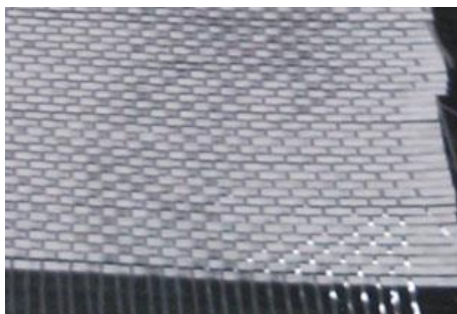
Figura 12 - Tecido unidirecional de fibra de vidro para reforço do sanduíche.
