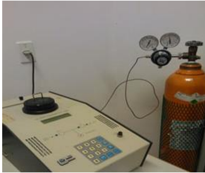
Figura 13 - Equipamento utilizado para a picnometria a gás Hélio.
