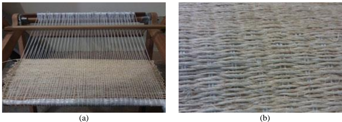
Figura 9 - a) Desenvolvimentos dos tecidos de sisal Simples em tear manual. b) Tecido de sisal Tramado Sarja (direita).
