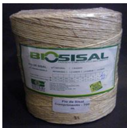
Figura 8 - Fio de sisal (700 m/kg) para desenvolvimento dos tecidos.
