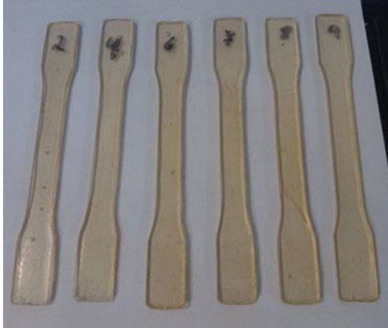
Figura 20 - Corpos de prova de resina poliéster para ensaio de tração.
