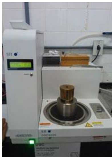
Figura 15 - Equipamento utilizado para análise de Calorimetria Exploratória Diferencial (DSC) dos constituintes.
