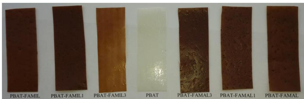
**Figura 65.** Ilustração dos filmes processados por extrusão.
