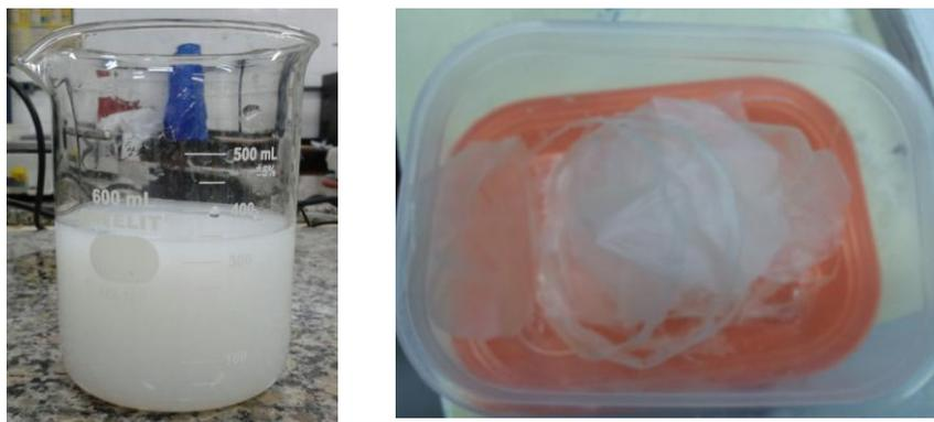
**Figura 24.** (a) Suspensão dos *nanowhiskers* de celulose em solução aquosa e (b) *nanowhiskers* de celulose seca em estufa.
