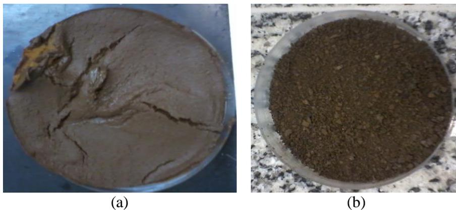
**Figura 35.** Ilustração da lignina precipitada (a) e seca (b).
