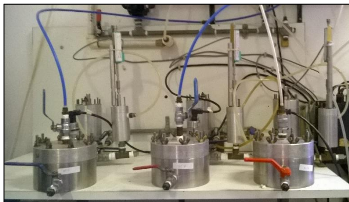
Figura 5. 39: Câmara do ensaio de sucção fechada com aplicação de ar aplicada no topo.
