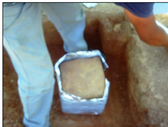
Figura 5. 28: Amostra sendo embalada para transporte até o laboratório.
