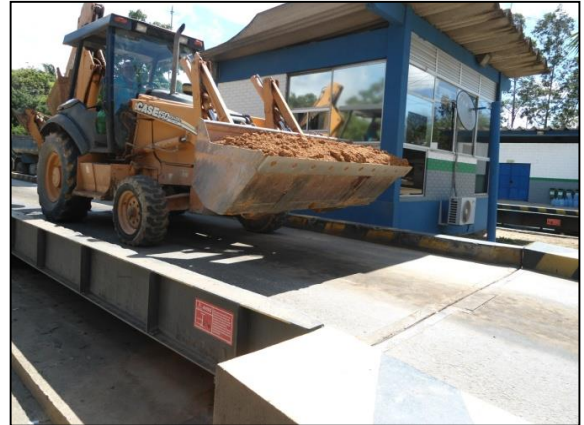
Figura 5. 4: A retro escavadeira sendo pesada com a concha cheia de solo Granulito.
