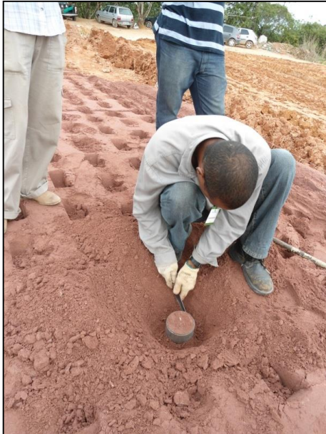
Figura 5. 17: Solo sendo amostrado para verificação da umidade de grau de compactação da camada.
