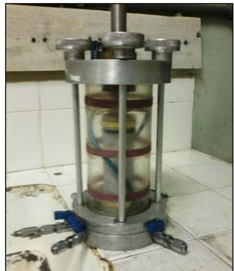
Figura 5. 33: Câmara de ensaio triaxial com o CP para o ensaio de permeabilidade.
