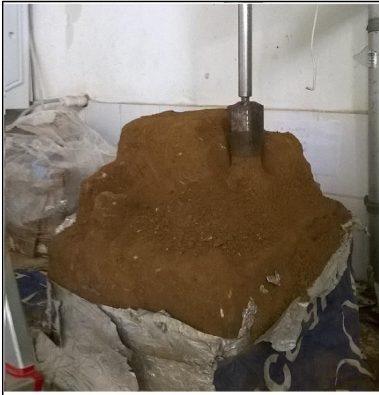
Figura 5. 35: CP do ensaio de sucção sendo talhado no bloco indeformado.
