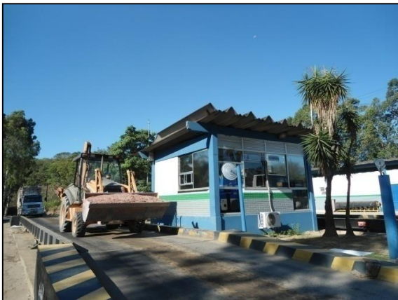
Figura 5. 5: A retro escavadeira sendo pesada com a concha cheia de solo Barreiras.
