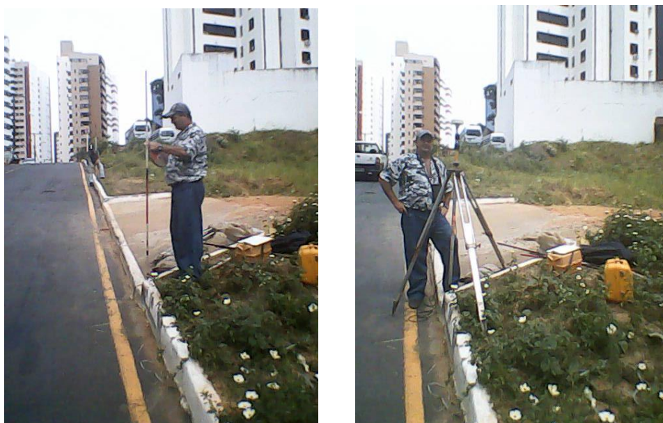
Figura 35 – Trabalho de campo – medição com trena e rastreamento GNSS – estudo de caso 2
