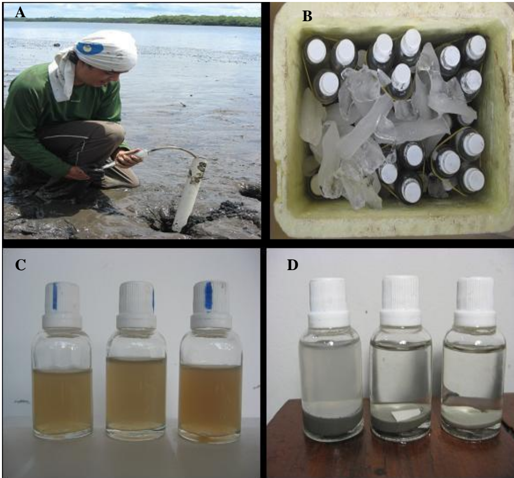
Anexo 1- Fotos do procedimento de coleta e processamento da água intersticial. A - extração em campo da água intersticial no habitat entremaré; B – Refrigeração das amostras em campo; C - início da decantação do sedimento da água intersticial e D - final da decantação.
