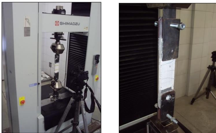
Figura 31. Esquema do ensaio de tração.
