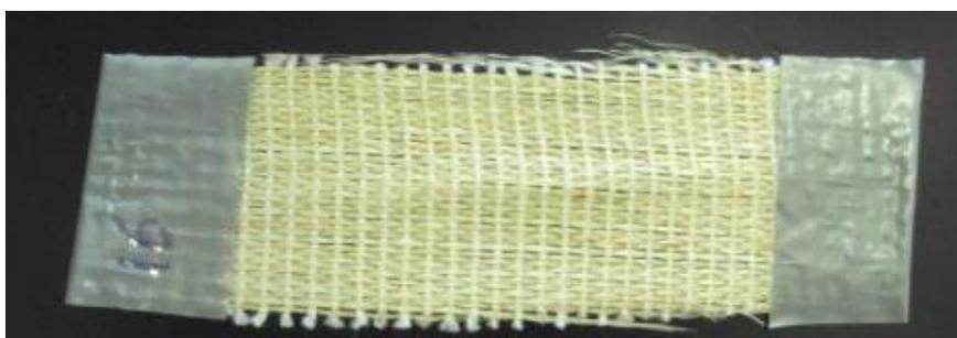
Figura 14. Corpo de prova com tecido de sisal.
