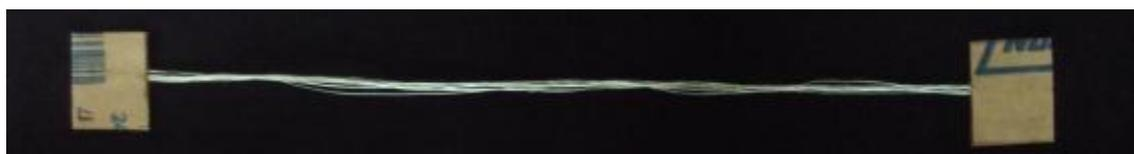
Figura 11. Corpo de prova com feixe de fibra de sisal.
