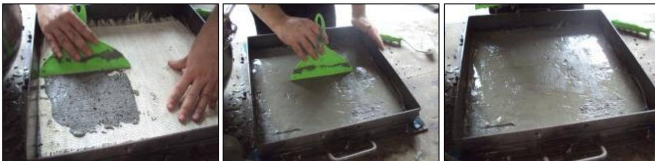
Figura 24. Aplicação da segunda camada de argamassa – distribuição com uma espátula.
