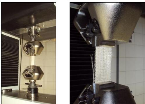
Figura 15. Ensaio de tração no tecido de sisal.
