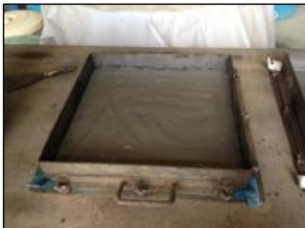
Figura 22. Primeira camada de argamassa com 2 mm de espessura.
