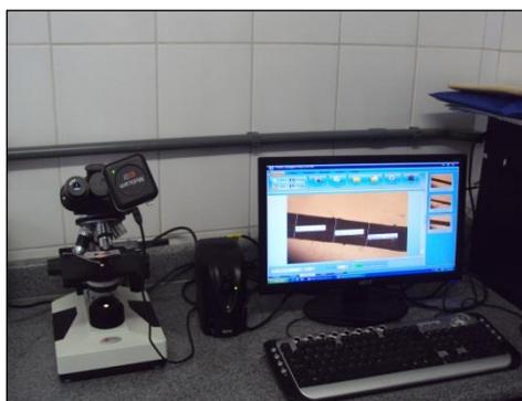
Figura 8. Determinação diâmetro da fibra através de microscópio.
