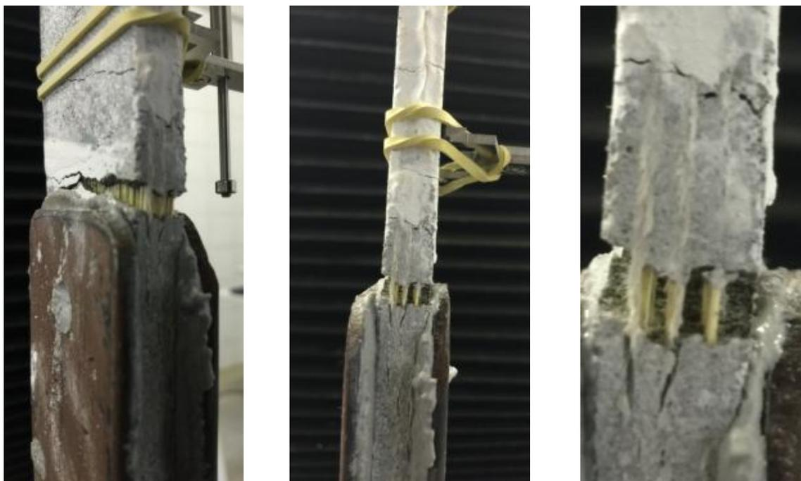
Figura 49. Detalhe da propagação da fissura na placa Fx3C.
