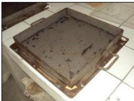
Figura 20. Forma metálica com desmoldante aplicado.
