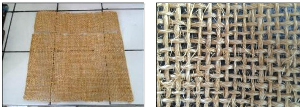
Figura 5. Tecido com espaçamento de 5 mm nas duas direções. Fio 700
