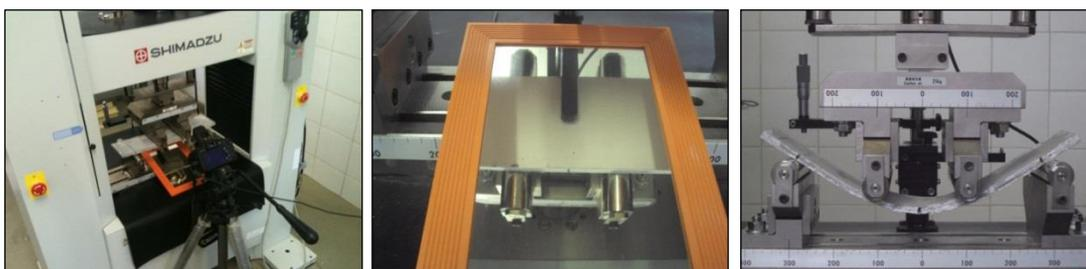
Figura 32. Ensaio de flexão em 4 pontos.
