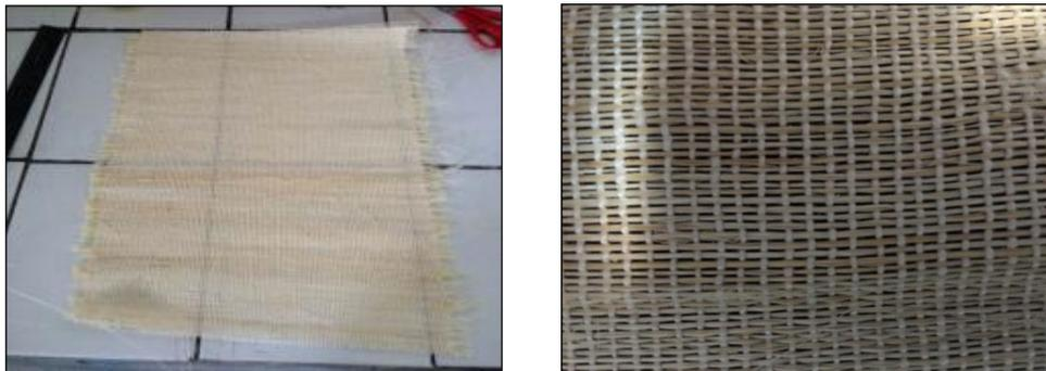
Figura 6. Tecido com espaçamento de 5 mm no urdume e 1 mm na trama. Feixe de fibras.
