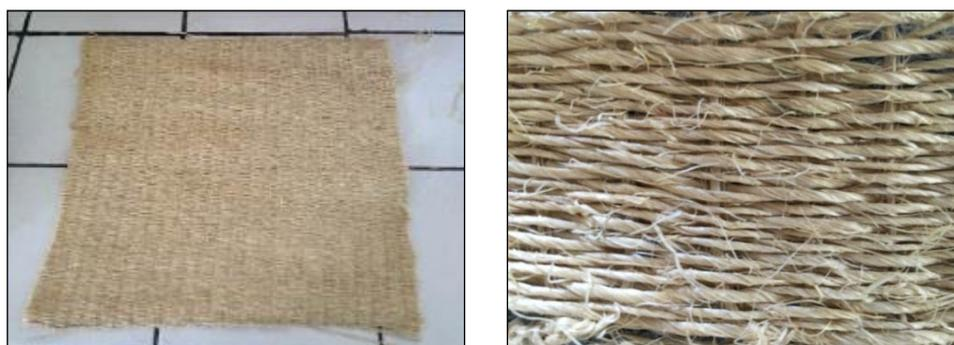
Figura 4. Tecido com espaçamento de 15 mm no urdume. Fio 700.
