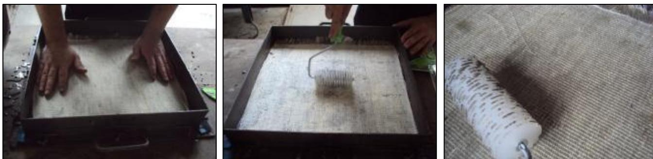
Figura 23. Aplicação da primeira camada de tecido – compactação com rolo de náilon.
