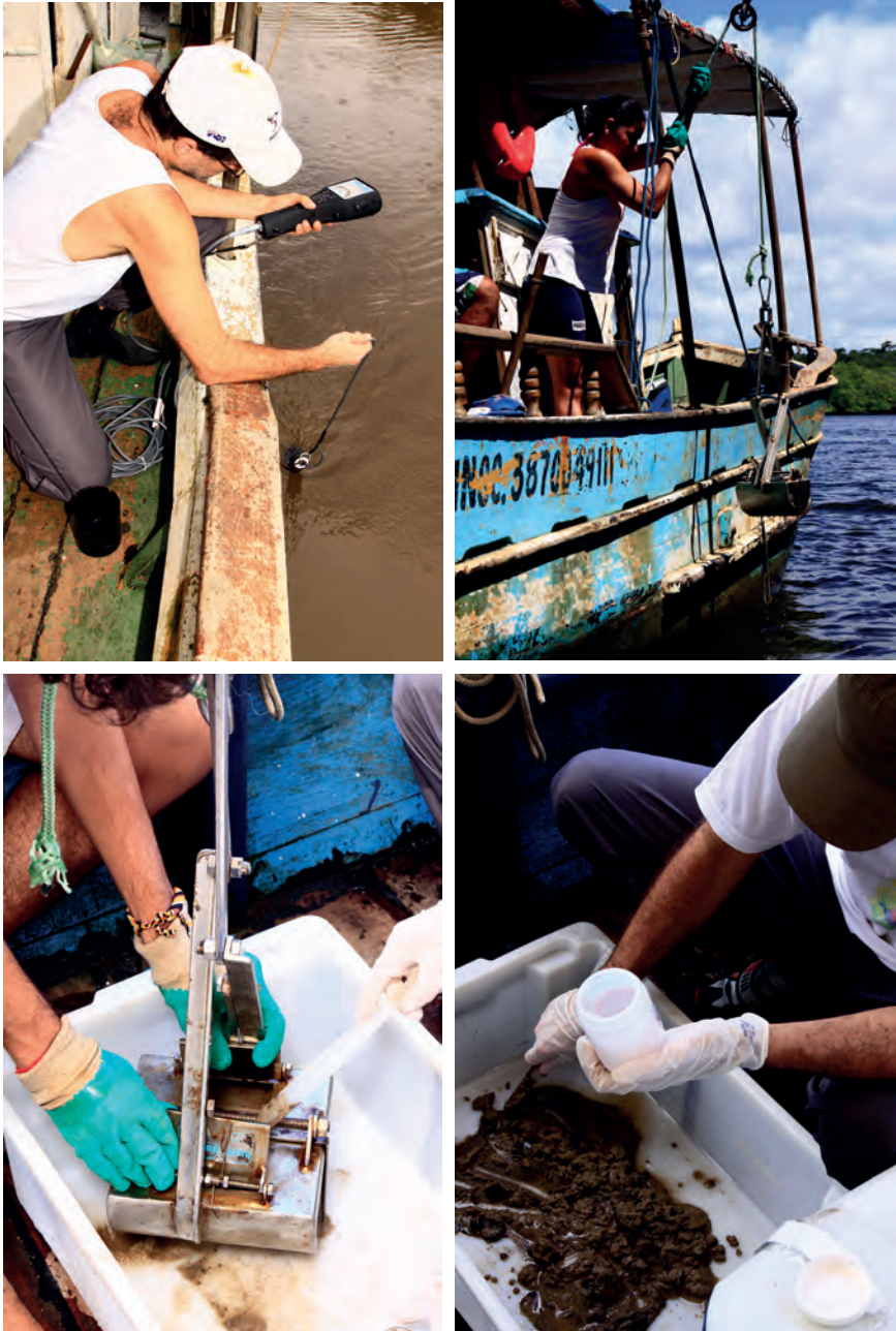
Figura 4 – (a) Medição dos parâmetros físicos-químicos da água com sonda multiparâmetros e procedimentos de coleta de sedimentos de fundo; (b) com amostrador tipo Van Veen; (c) abertura do amostrador Van Veen; e (d) visualização da amostra coletada
