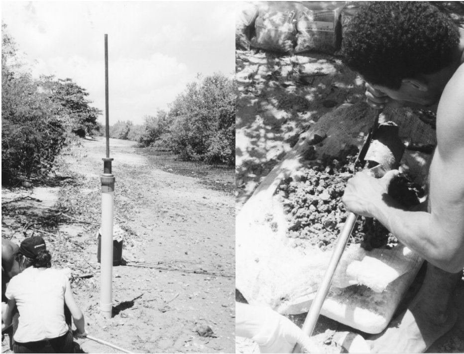
Figura 10.12 – Atividades de execução de furo de sondagem à trado, com cravação de revestimento externo de PVC e coleta das amostras de solo.
