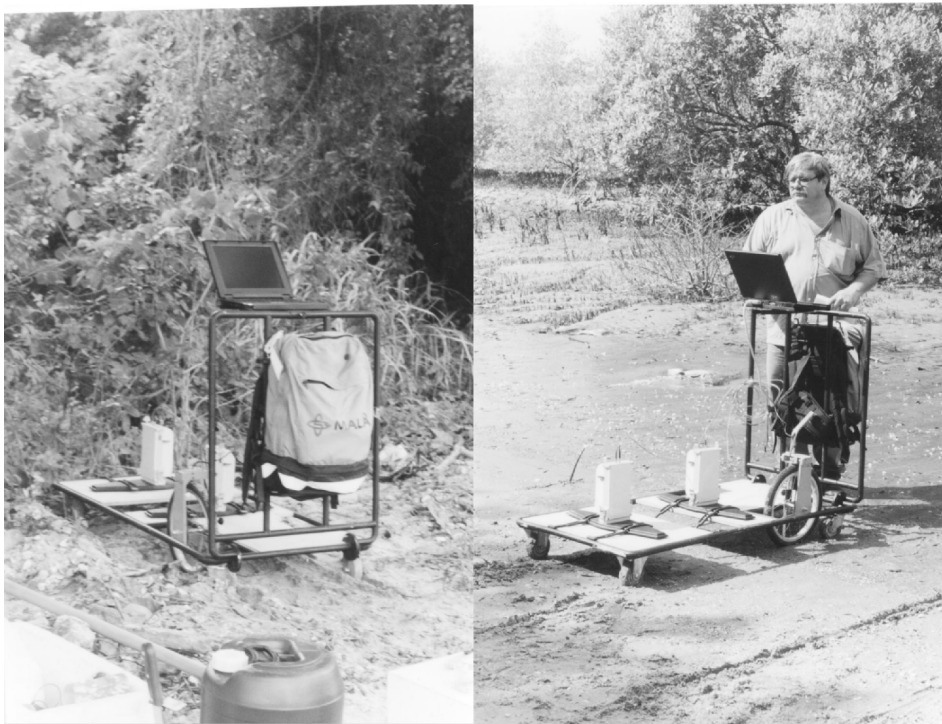
Figura 10.13 – Foto ilustrativa da realização de ensaios de radar am campo. Equipamento de radar composto de odômetro, antenas (200 MHz), Microcomputador e CPU.
