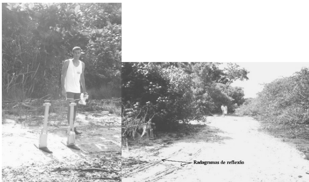
Figura 10.14 - Posicionamento das antenas de radar nos ensaios do tipo CMP e área utilizada para a realização dos ensaios de “offset” constante, durante a terceira campanha de investigação.
