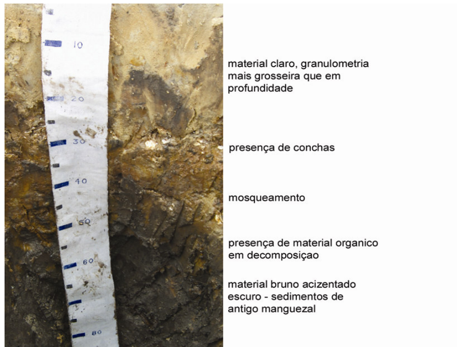
Figura 2.6 - Perfil típico encontrado nos apicuns na Baía de Todos os Santos, BA.
