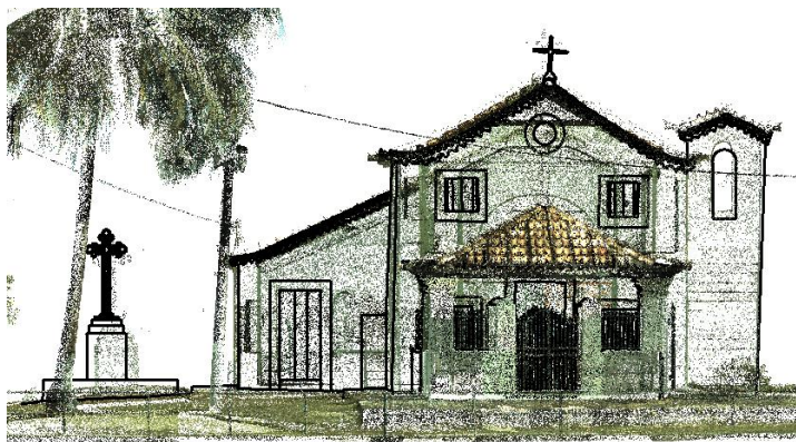
Figura 171 - Fachada lateral direita: sobreposição da "nuvem de pontos" com o desenho por medição direta
