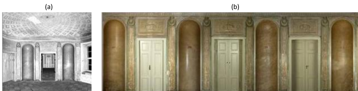
Figura 66 - (a) "nuvem de pontos" do interior de uma edificação; (b) ortofoto planificada no programa LupoScan
