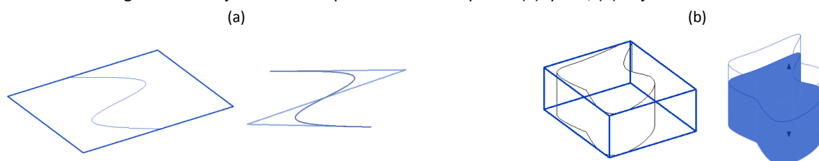
Figura 153 - Objetos antes e após o comando Explode : (a) spline ; (b) objeto sólido
