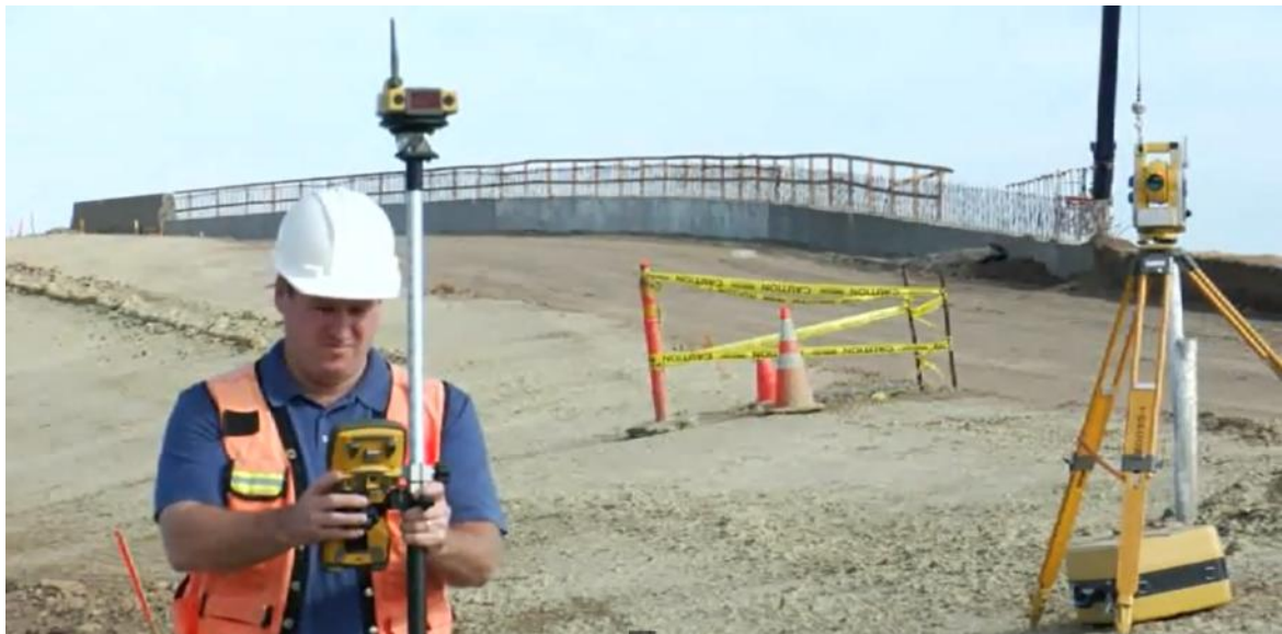
Figura 8 - Estação total robotizada: à esquerda o dispositivo de controle, o sistema de rádio e o prisma, e à direita a estação total sobre tripé
