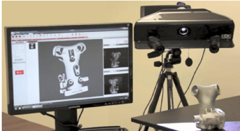
Figura 27 - O sistema HDI Advance R3 (pro) durante um escaneamento, permitindo o registro da forma no software FlexScan3D PRO
