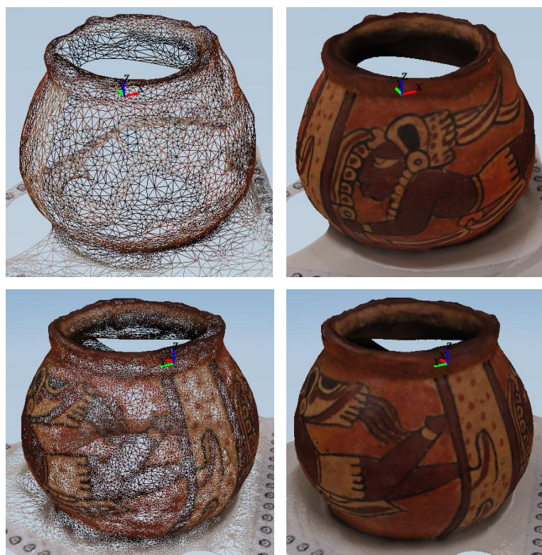
Figura 113 - Visualização em wireframe e com preenchimento das faces, nas resoluções baixa (imagens superiores) e média (imagens inferiores) do 123D Catch
