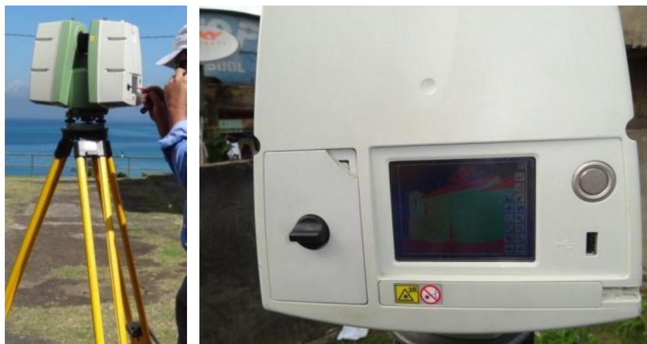
Figura 160 - (a) Laser scanner Leica ScanStation C10 sobre tripé; (b) detalhe da unidade de controle com a "nuvem de pontos" gerada
