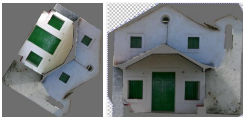
Figura 179 - (a) Seleção da textura da fachada principal; (b) rotação e edição da ortofoto
