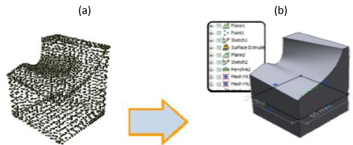
Figura 91 - Terceira geração de programas: (a) "nuvem de pontos"; (b) modelo paramétrico
