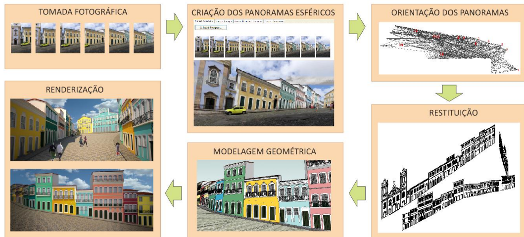
Figura 16 - Etapas básicas da fotogrametria esférica até a obtenção do modelo renderizado
