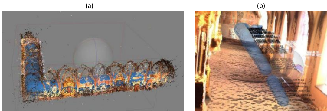
Figura 21 - Geração do modelo geométrico de um trecho do claustro no Agisoft Photoscan: (a) "nuvem de pontos"; (b) malha triangular com posicionamento dos panoramas 360° (em azul)
