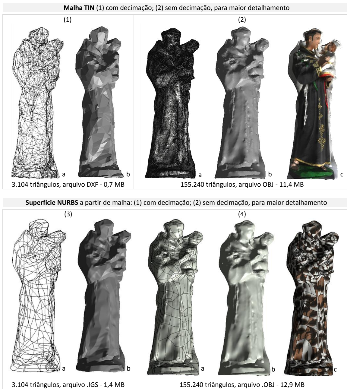
Figura 237 - Produtos gerados no Gemagic Studio e importados no Revit: malha TIN e superfície NURBS
