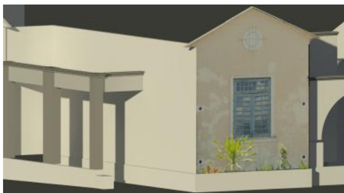
Figura 135 - Aplicação de textura no elemento "parede" do Revit, utilizando a ortofoto correspondente
