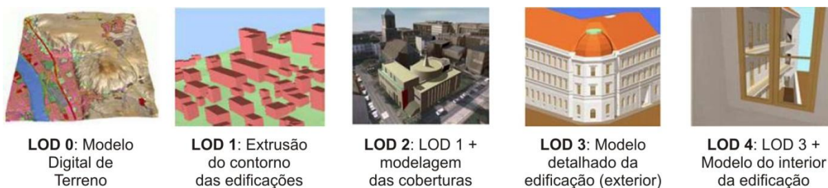
Figura 105 - Os cinco níveis de detalhe (LOD 0 a 4) definidos pelo padrão CityGML
