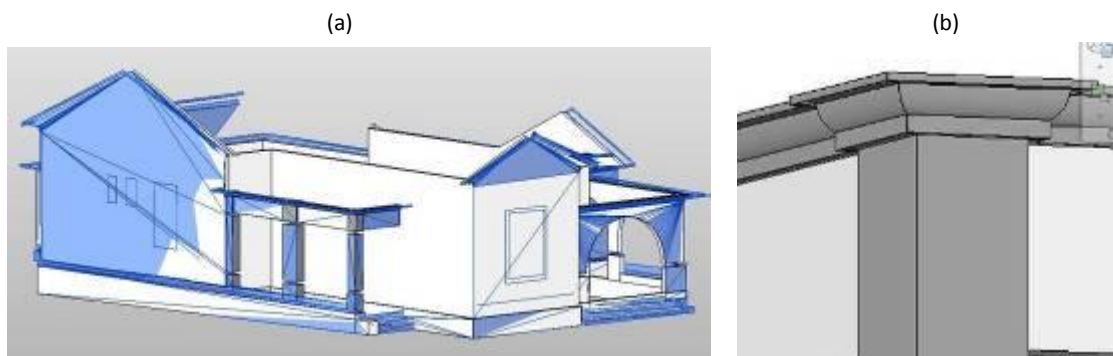
Figura 134 - Modelo parcial da edificação gerado no Revit, a partir do modelo de superfícies do PhotoModeler: (a) sobreposição do modelo BIM com o de superfícies; (b) detalhe de um ornamento modelado
