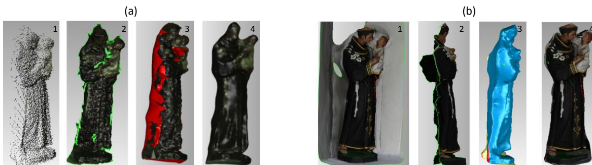
Figura 233 - Operações sobre o modelo da estátua: (a) gerado por varredura a laser; (b) gerado por DSM
