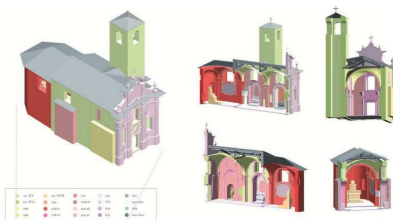
Figura 101 - Uso de diferentes cores para representar as principais fases construtivas da Igreja de Santa Maria
