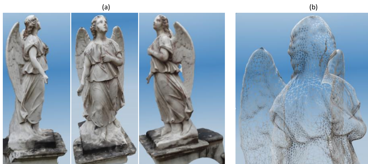
Figura 118 - Malha triangular texturizada de uma estátua gerada no 123D Catch: (a) em diferentes ângulos com a visualização das faces; (b) em wireframe
