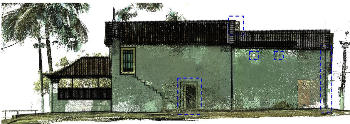
Figura 170 - Fachada lateral direita: sobreposição da "nuvem de pontos" com o desenho por medição direta
