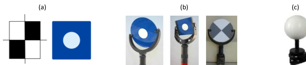
Figura 79 - Tipos de alvos para levantamento arquitetônico: (a) planos; (b) giratórios; (c) esféricos
