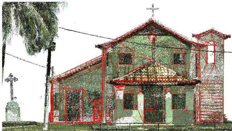
Figura 174 - Fachada principal: sobreposição dos modelos de "nuvem de pontos" e de superfícies (em wireframe , cor vermelha)
