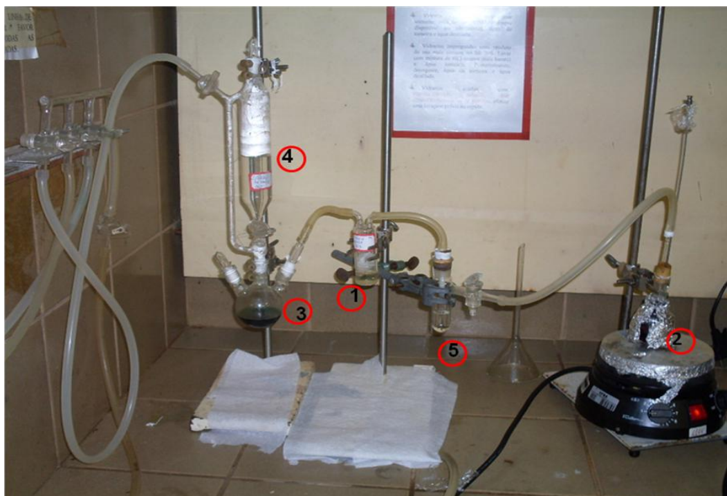
Figura 18. Sistema utilizado para sintetizar [\text{Ru}(\text{NO})\text{Cl}_3] . 1- Solução de hidróxido de sódio. 2- Solução metanólica de [\text{Ru}(\text{NO})\text{Cl}_3] . 3- Balão contendo cobre metálico. 4- Funil de adição adaptado para saída de gases; nele há solução de ácido nítrico 30%(v/v). 5- Metanol.
