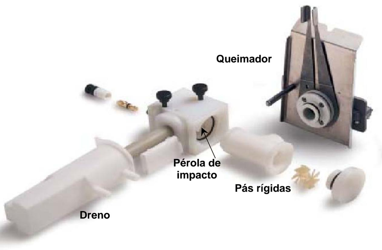
**Figura 6-** Figura de um queimador de pré-mistura.
