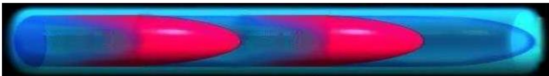
Figura 10. Ilustração de dois pulsos do analito separados por um certo intervalo de tempo em sistema de fluxo contínuo.
