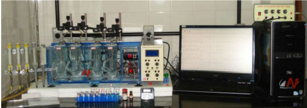
Figura 8: Sistema de cubas e aquisição de dados de tensão isométrica para órgão isolado.
