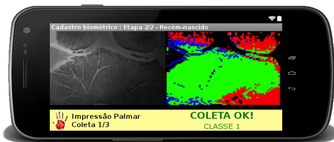
Figura 5: Resultado da qualidade. No topo está identificada a etapa do cadastro biométrico juntamente com o total de etapas necessárias para a finalização do cadastro. A esquerda, no centro está a imagem da impressão papiloscópica original. Ainda a esquerda, no rodapé em vermelho está identificada a região de interesse, um texto informando se a imagem coletada é uma imagem da impressão palmar ou plantar, e logo abaixo a informação numérica da coleta que está sendo executada, juntamente com o total de coletas a serem realizadas. A direita, no centro está o mapa da qualidade da impressão papiloscópica original. As áreas em verde, azul e vermelho representam, respectivamente, áreas com qualidade boa, regular ou ruim para o reconhecimento biométrico
