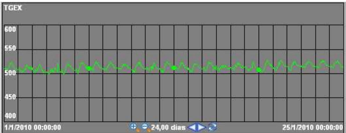
Figura 48 – Temperatura dos gases exaustos na TG3(1) (°C)
