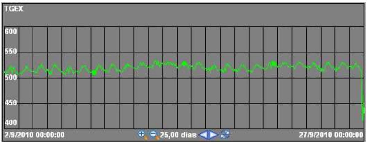
Figura 53 – Temperatura dos gases exaustos na TG3(2) (°C)
