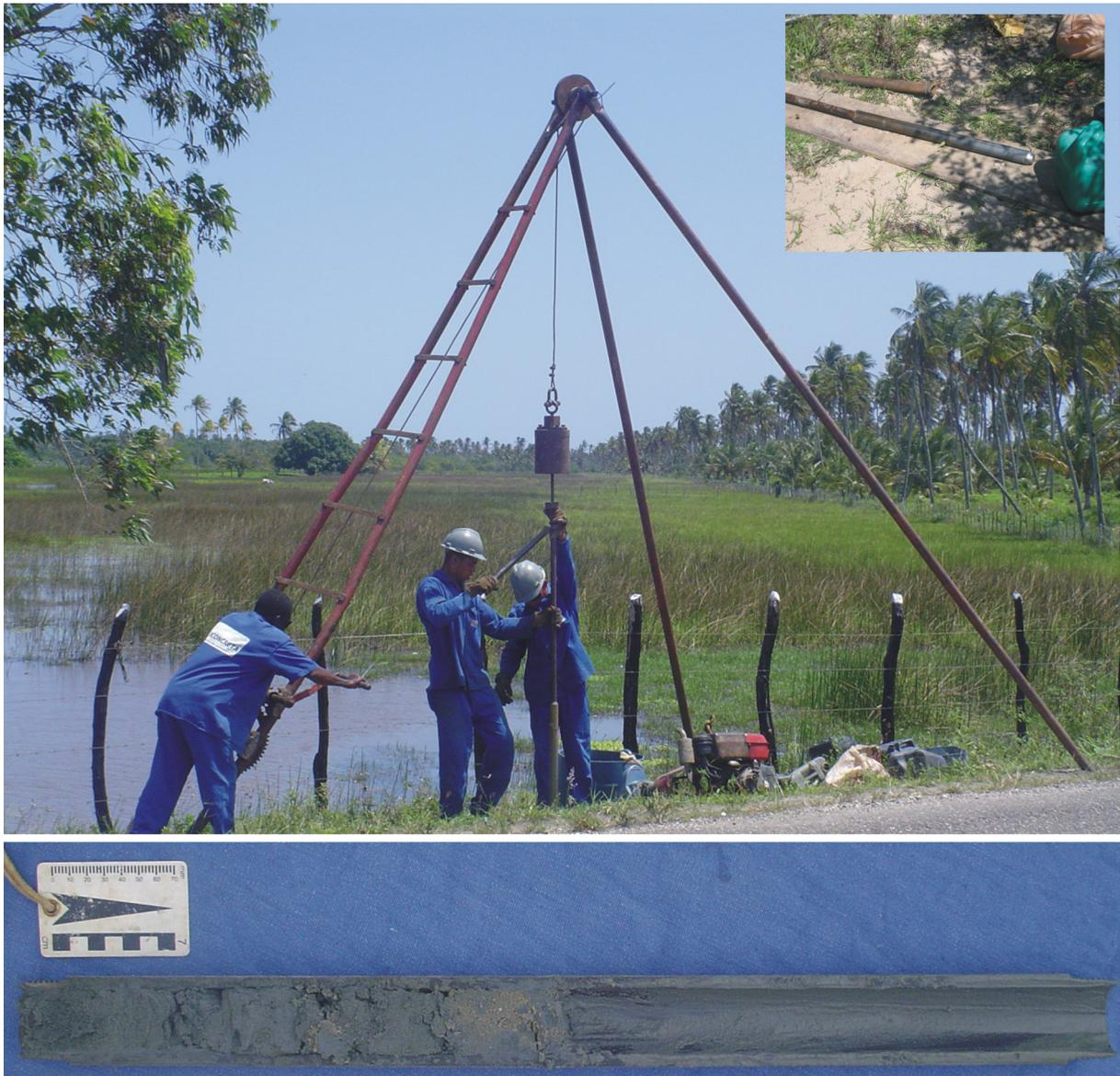
Fig. 2.2. Equipamento utilizado para a realização de sondagens SPT; no detalhe acima, amostrador fixado à haste; no detalhe abaixo, imagem de uma metade do amostrador com sedimentos.
